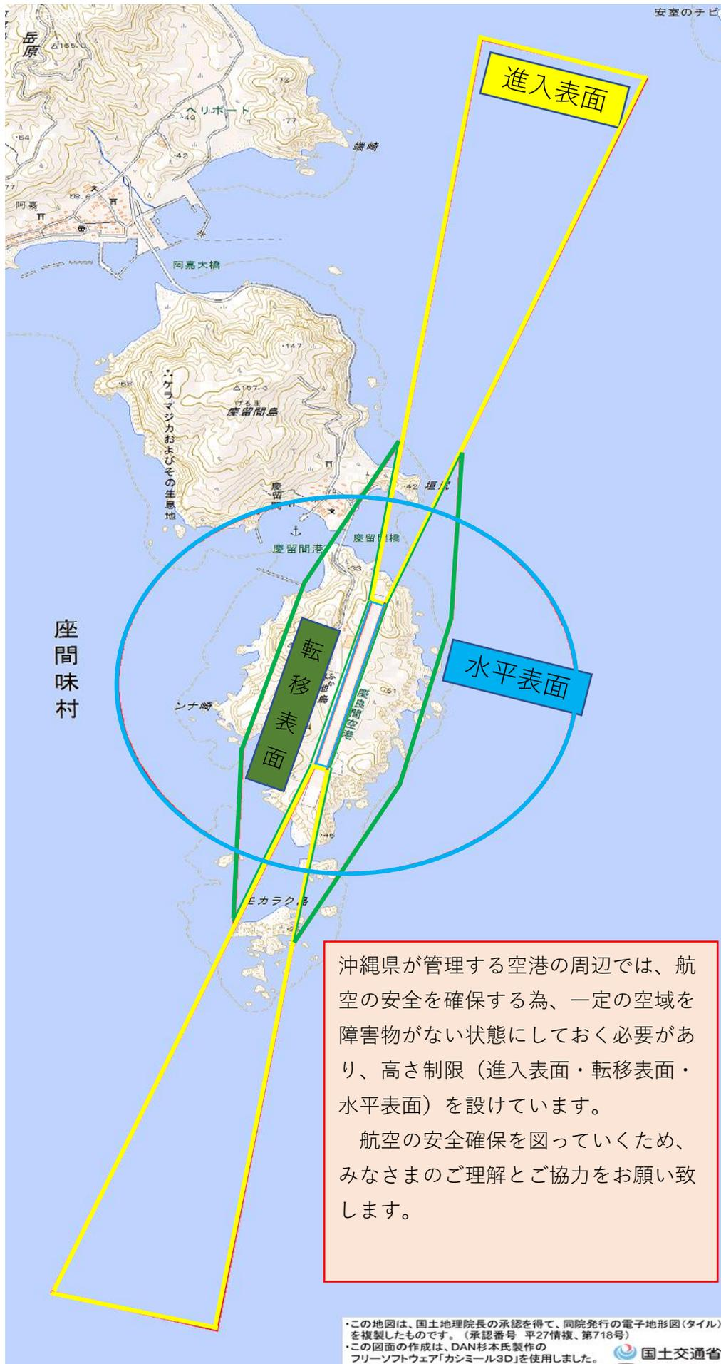
沖縄県が管理する空港の周辺では、航空の安全を確保する為、一定の空域を障害物がない状態にしておく必要があります、高さ制限（進入表面・転移表面・水平表面）を設けています。
